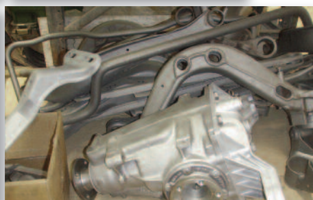
Differenzialgetriebe zusammgebaut: entlackt mit Wasserhöchstdruck und mit Glasperlen nachgestrahlt
