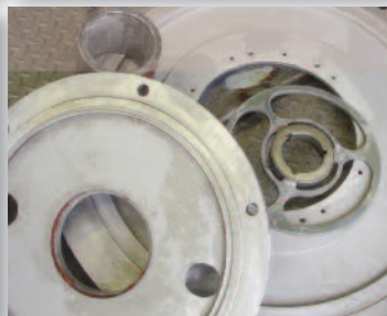
Mühlenteile mit PU-Anhaftungen, mit Rotordüse gereinigt
