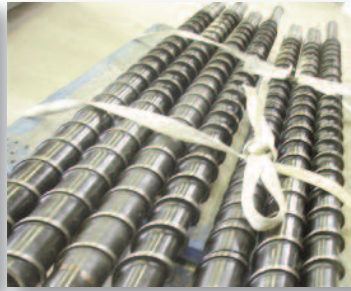
Reinigung von Extruderschnecken (Entfernung von Thermoplasten)
