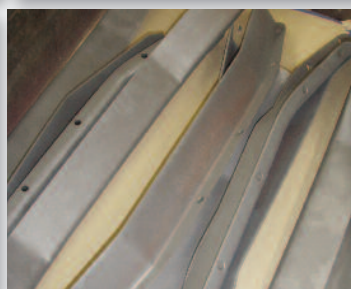
Entgummierung von gebrauchten Faltenbalgteilen
